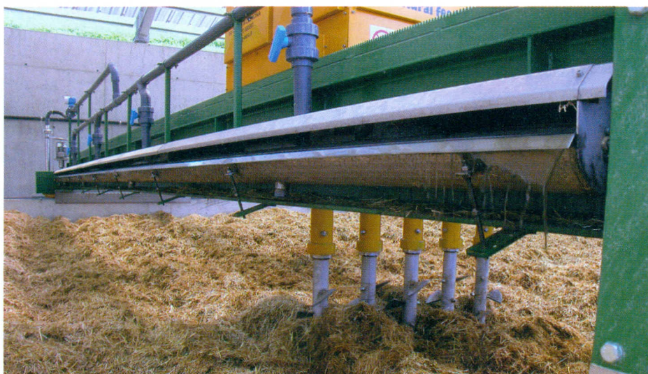
▼ Fondamentale il lavoro svolto dalle coclee: la foggia particolare e il loro movimento assicurano un rimescolamento continuo e peculiare della lettiera, che ad un passaggio viene portata dal basso verso l'alto e al passaggio successivo dall'alto verso il basso. Contemporaneamente dalle coclee viene insufflata dell'aria nella biomassa. Quando c'è lo spandimento del liquame le coclee si sollevano, permettendo così un agevole scorrimento del carroponete.
